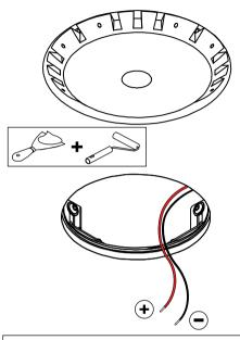
350mA - min 29,1Vf - max 33,7Vf - 11W 500mA - min 29,9Vf - max 34,7Vf - 16,2W 700mA - min 31,0Vf - max 35,8Vf - 23,4W 900mA - min 31,7Vf - max 36,9Vf - 31 W
